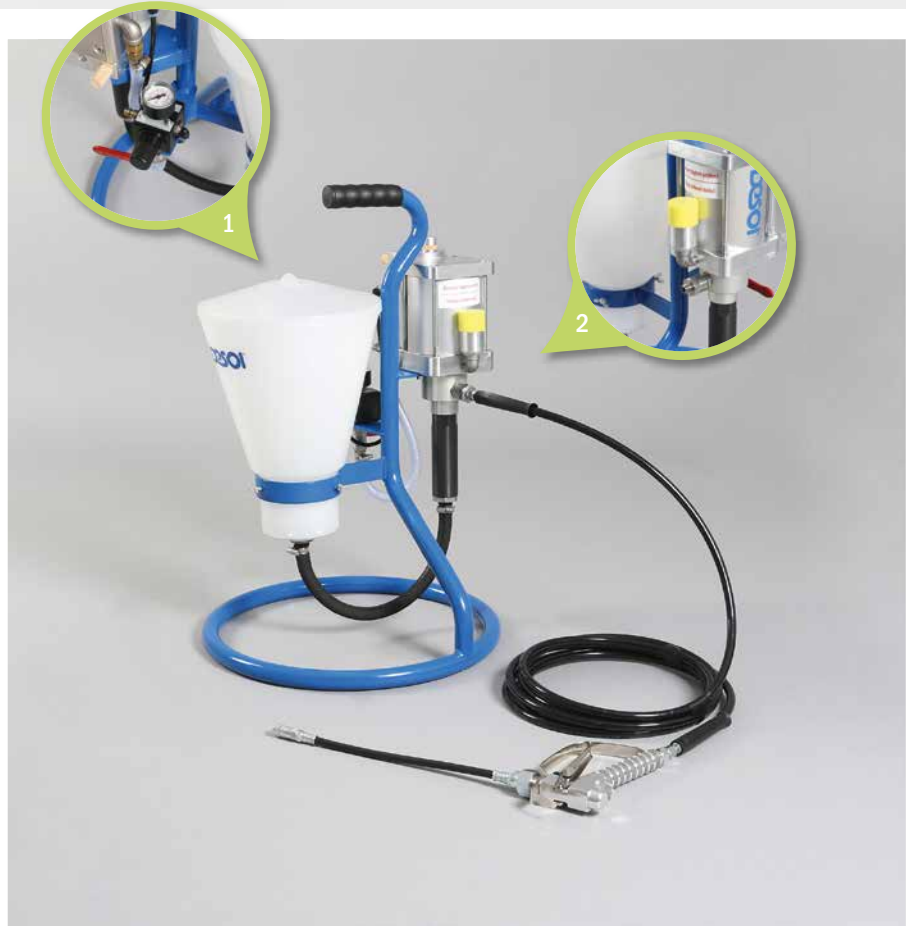
1. Druckminderer mit Manometer | Pressure regulator with manometer
